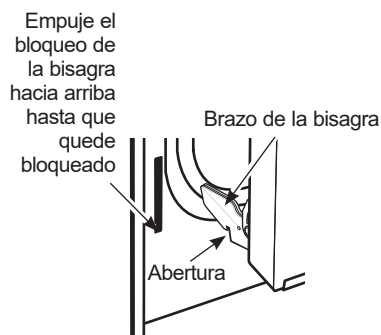
Empuje el bloqueo de la bisagra hacia arriba hasta que quede bloqueado
